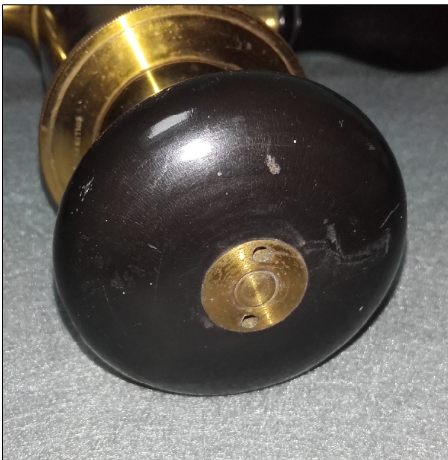
Figure 508 : bouton en bois, large, pour appui sur le torse de l'opérateur, sur une seringue anatomique. © Coll. De l'auteur.
