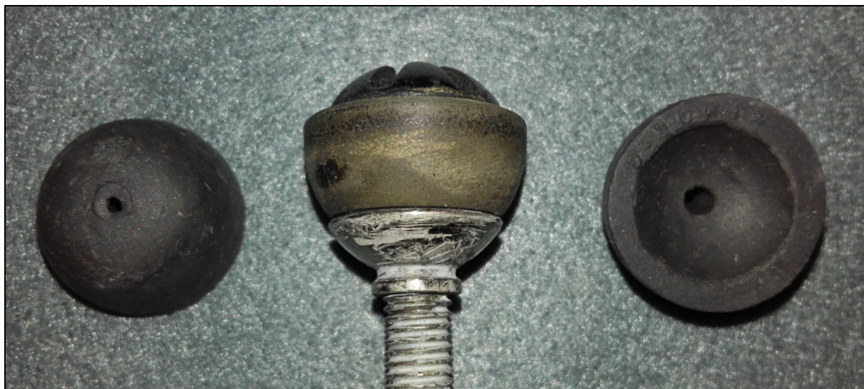
Figure 505 : joint en Durit o sur une seringue de Roux. Le joint porte la mention en relief « Durit ». © Coll. De l'auteur.
