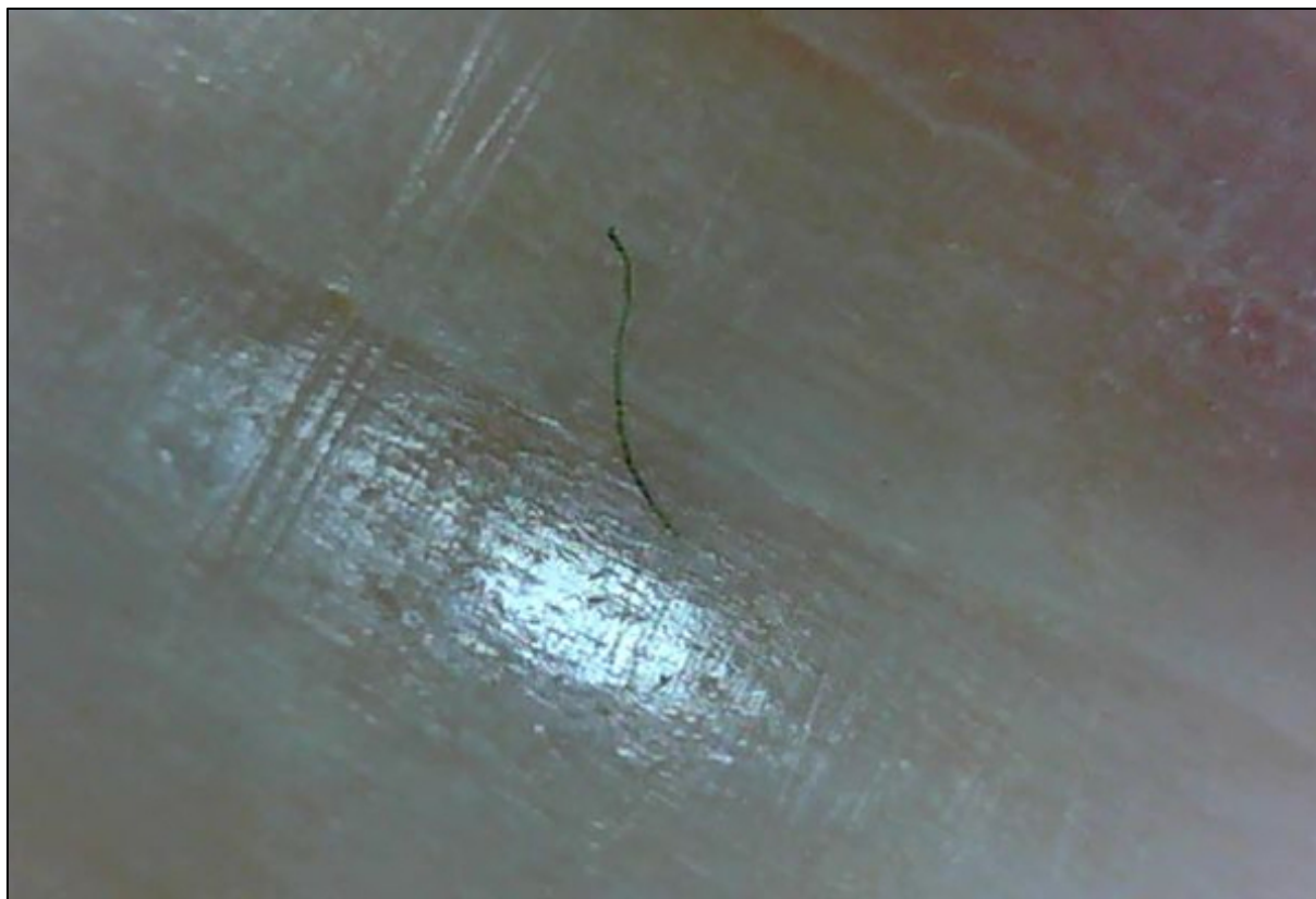
Figure 494 : fibre de textile verte incluse dans l'os, suite au polissage par un tissu. Microscope USB X 200. © Coll. De l'auteur.
