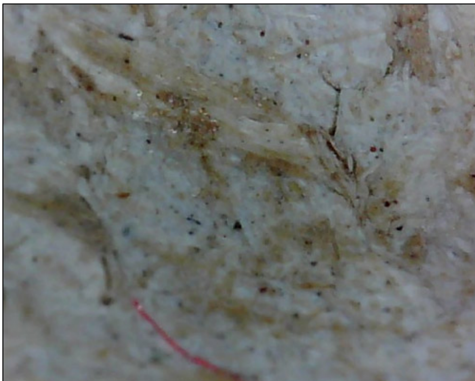
Figure 103 : Le joint d'amiante, vue au grossissement X 250, montrant diverses impuretés et les fibres se détachant. © Coll. De l'auteur.
