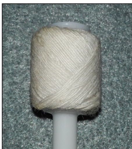
Figure 501 : joint en fil de coton tassé par un fil entrecroisé. © Coll. De l'auteur.
