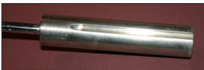
Figure 43 : piston à rigole du pleuro-laveur, copie conforme de celui de la seringue de Jubé. © Coll. De l'auteur.
