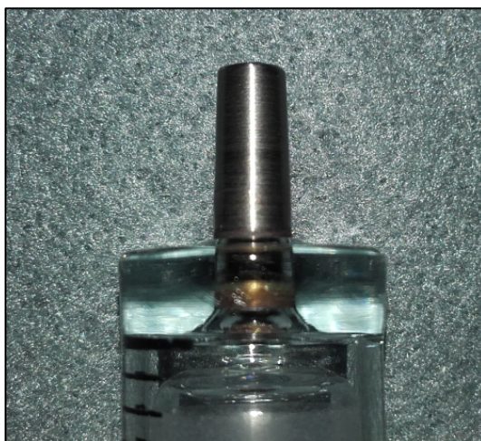
Figure 512 : cône Lüer à 6% sur une seringue hypodermique. © Coll. De l'auteur.
