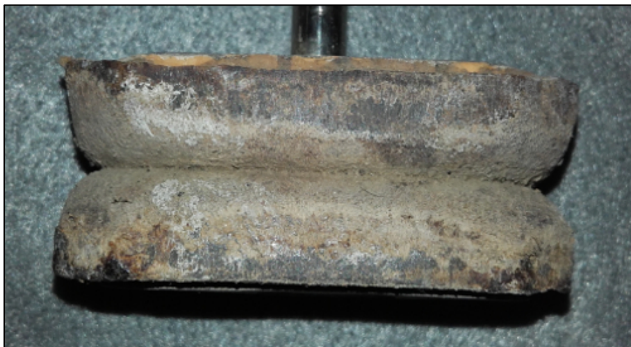
Figure 389 : Joint en cuir de type double parachute, monté sur liège. © Coll. De l'auteur.
