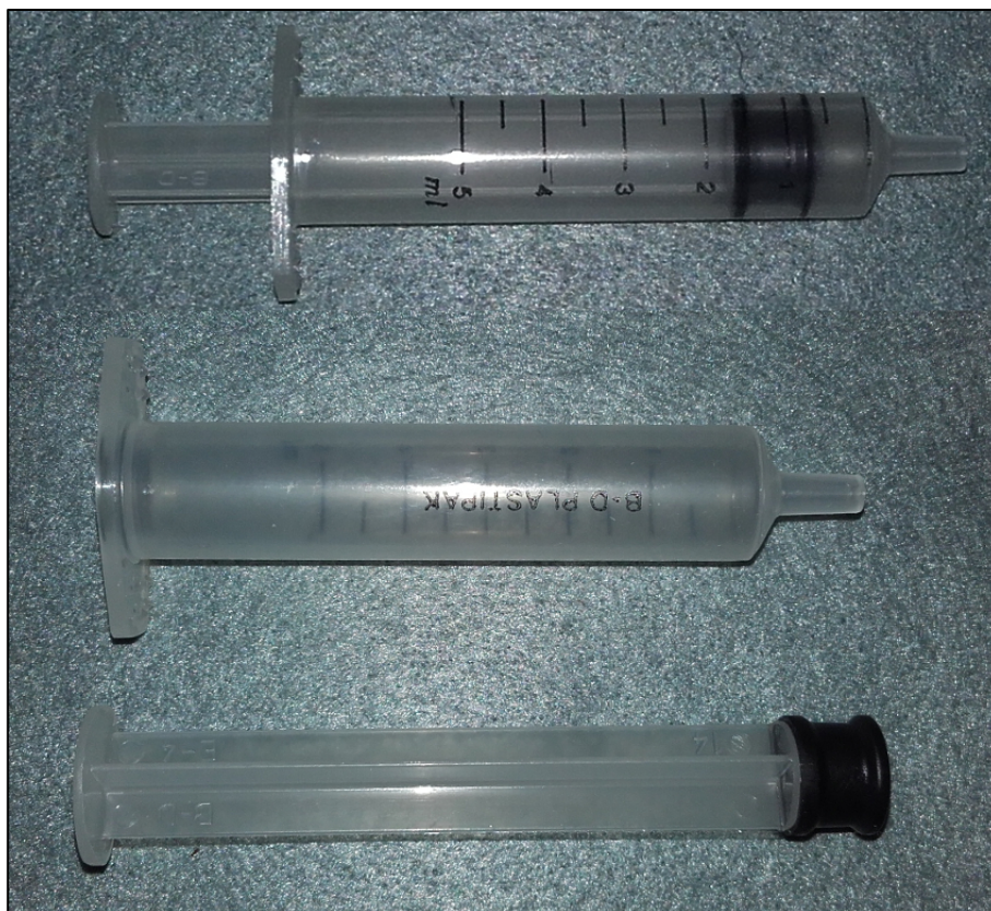
Figure 127 : seringue Plastipak ® datée de 1976, à trois pièces, corps de pompe, piston, joint en élastomère. © Coll. De l'auteur.
