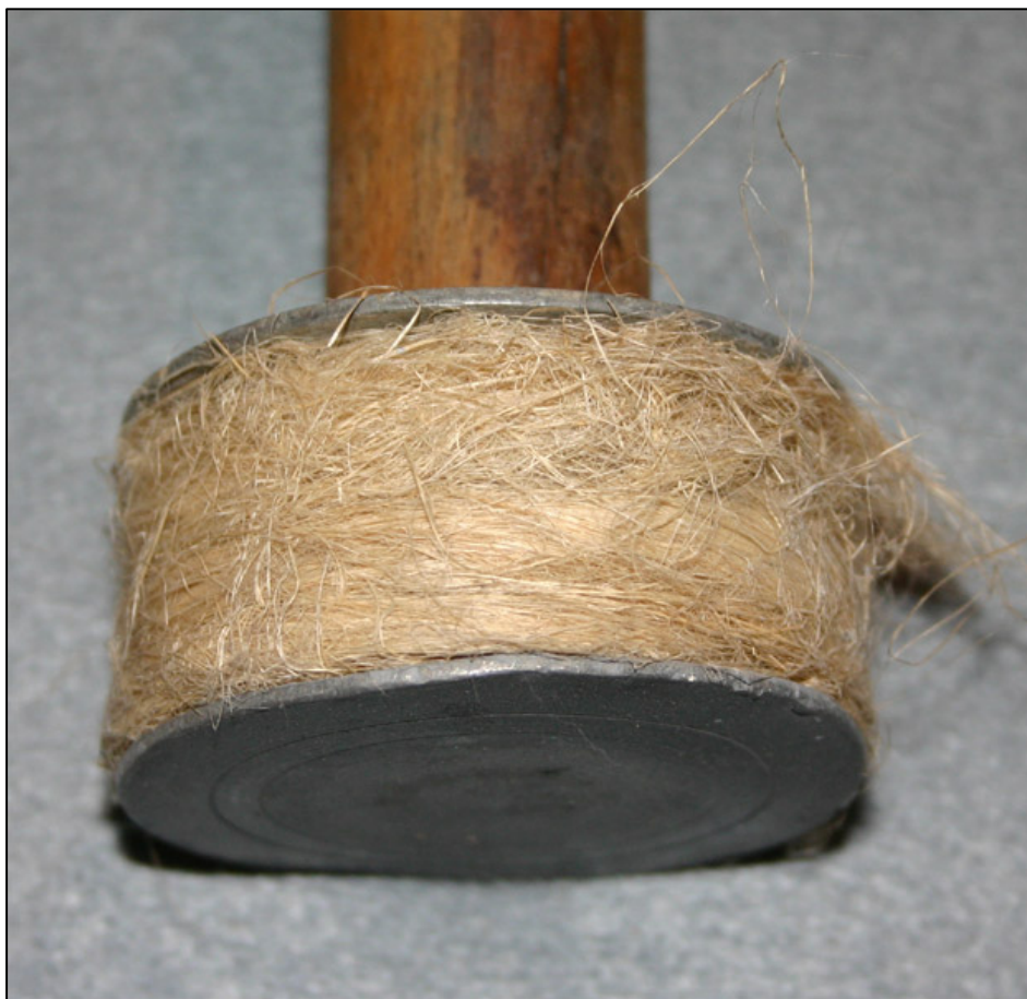
Figure 496 : joint composé de deux rondelles métalliques enserrant un paquet de filasse enroulé autour de la tige du piston d'un clystère, XIX e . © Coll. De l'auteur.
