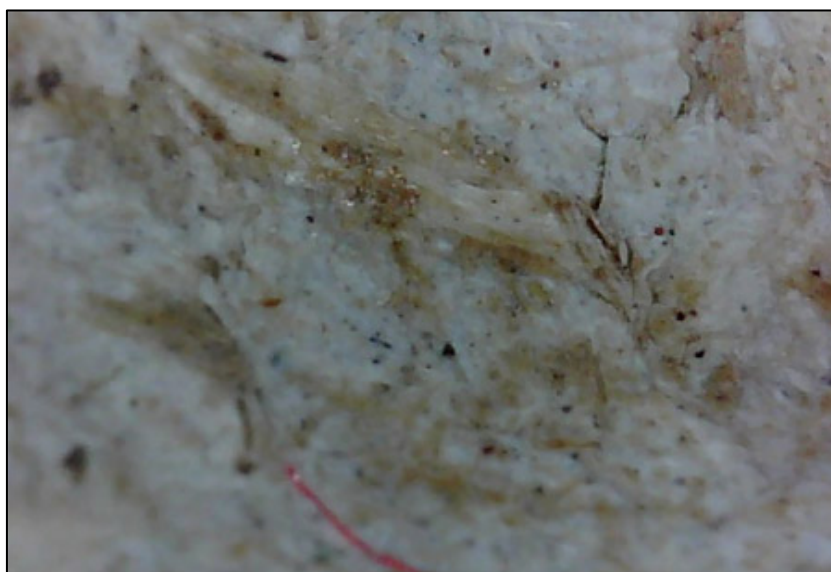
Figure 500 : joint en amiante (grossissement X 150) montrant les fibres se détachant. © Coll. De l'auteur.
