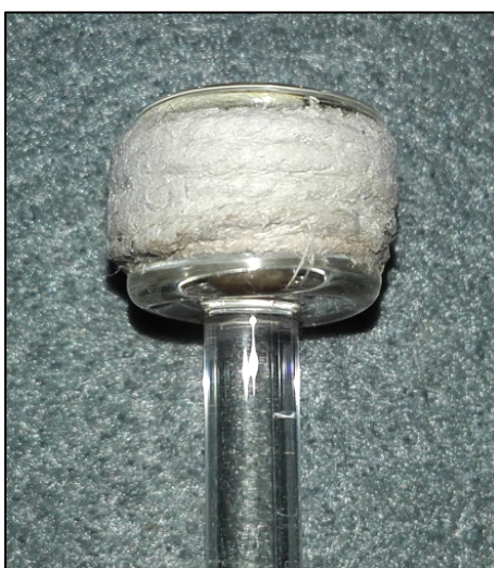
Figure 499 : joint en fil de coton bobiné. © Coll. De l'auteur.
