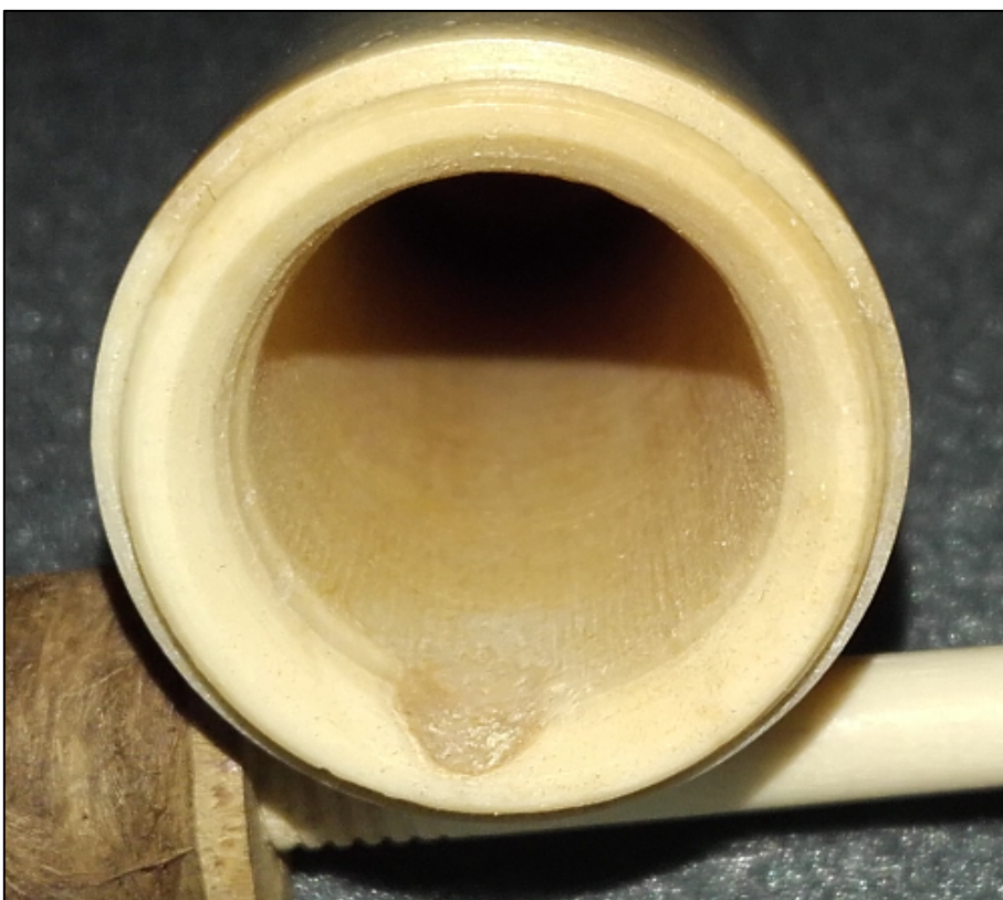
Figure 492 : corps de pompe de seringue en os évidé au tour. © Coll. De l'auteur.
